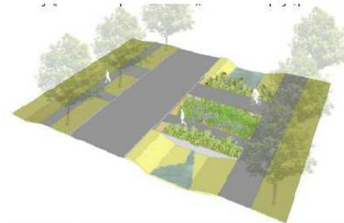
**Filtre à sable : schémas de principe**
